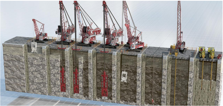
Ilustración 18. Esquema general de ejecución de muros pantalla con Hidrofresa (Fuente: Soletanche bachy)
