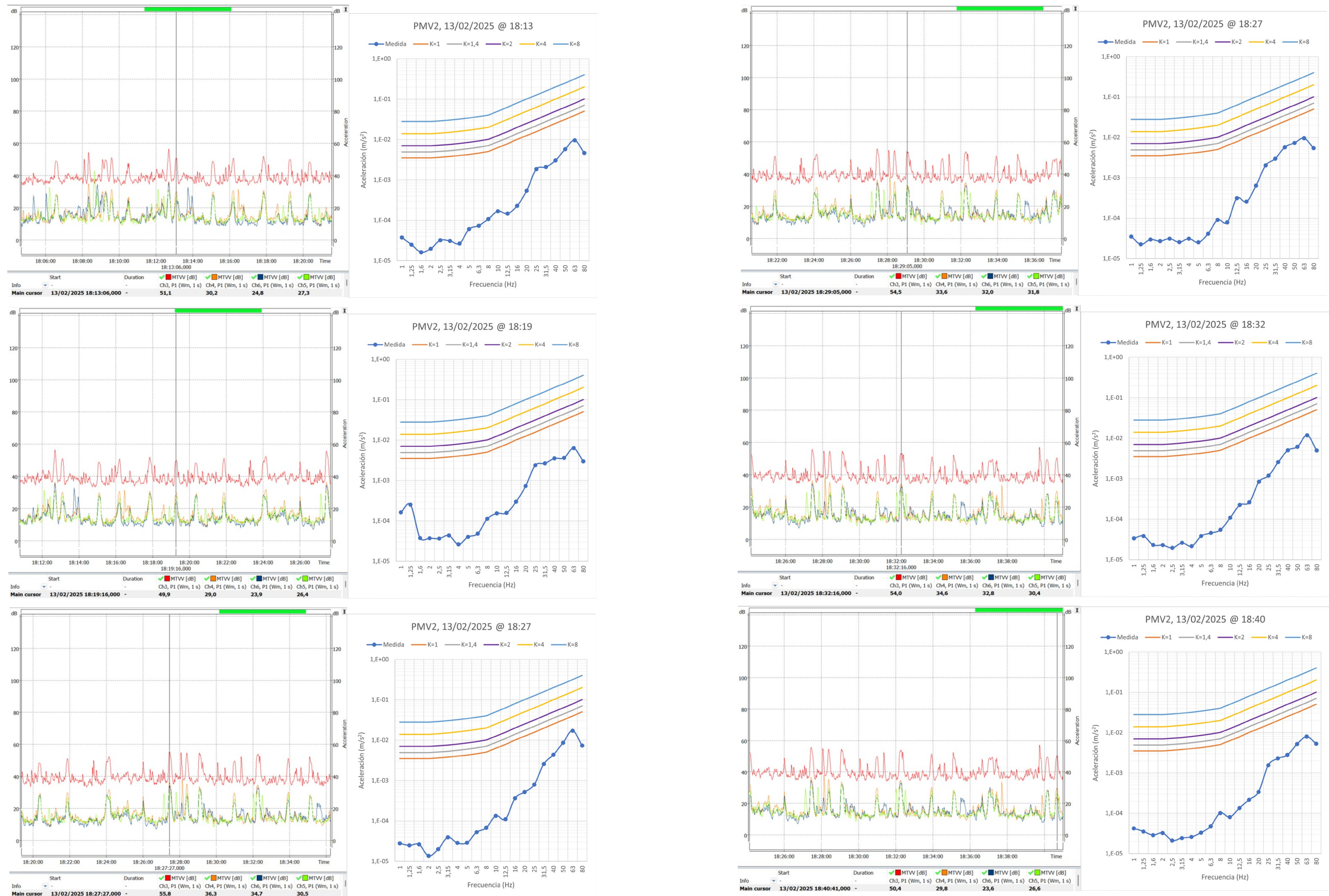
ILUSTRACIÓN 8 - REGISTROS TEMPORALES Y ESPECTROS DE VIBRACIÓN ACTUAL
